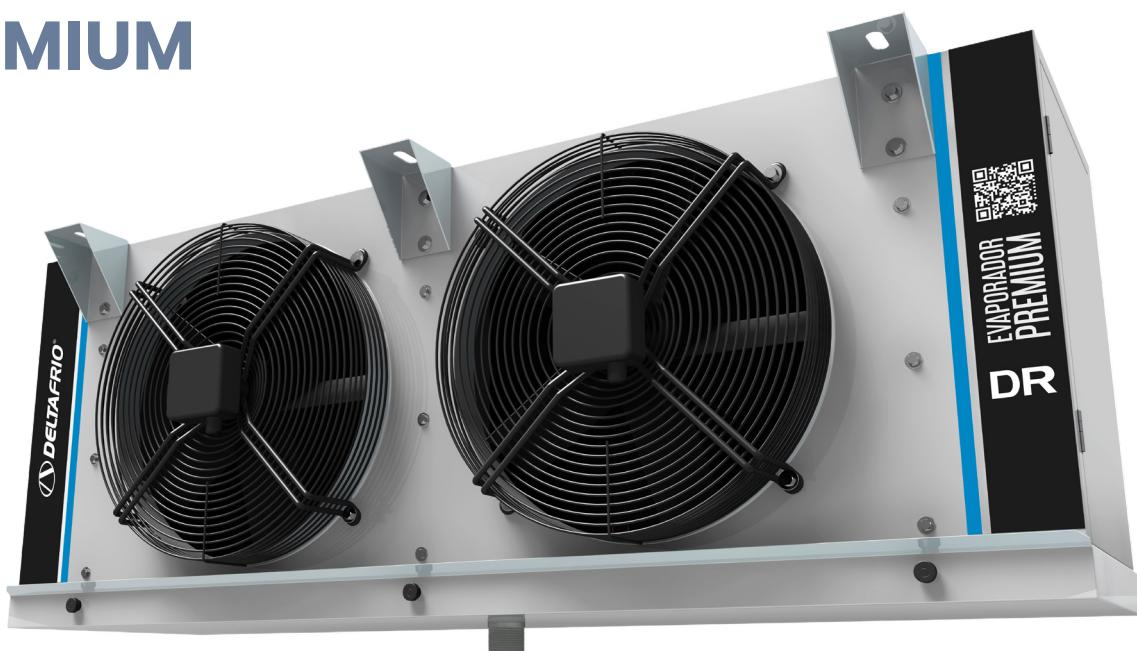
Os evaporadores da linha DR são confeccionados sempre com aletas de alta espessura (0,30mm), garantindo máxima eficiência da serpentina devido ao elevado fator de contato tubo X aleta (fig. 1), bem como, elevada resistência mecânica do aletado para suportar processos de limpeza e os efeitos de dilatação X contração decorrentes dos processos de degelo. Toda a serpentina é fabricada no conceito de tubos de fluido flutuantes (fig. 2), que garante que nunca haverá vazamento por atrito na tubulação.
