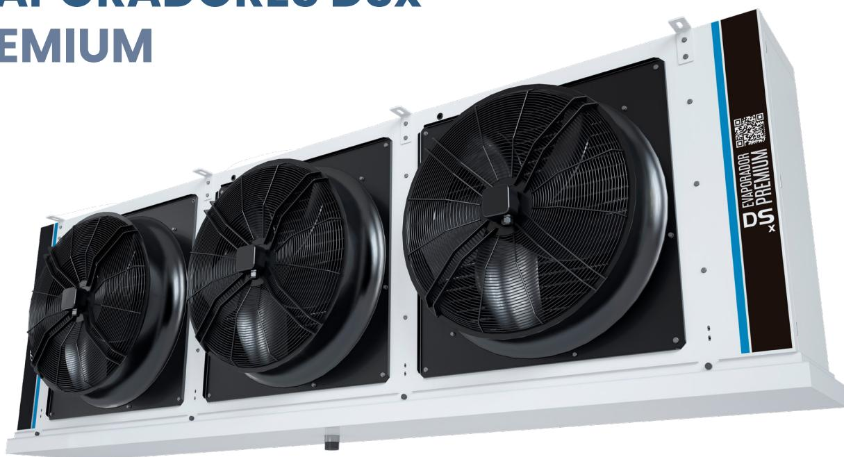
Os evaporadores da linha DSx são confeccionados sempre com aletas de alta espessura (0,30mm), garantindo máxima eficiência da serpentina devido ao elevado fator de contato tubo X aleta (fig. 1), bem como, elevada resistência mecânica do aletado para suportar processos de limpeza e os efeitos de dilatação X contração decorrentes dos processos de degelo. Toda a serpentina é fabricada no conceito de tubos de fluido flutuantes (fig. 2), que garante que nunca haverá vazamento por atrito na tubulação.
